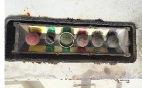
(4) لوحة التحكم بجهاز الرفع (5) مفاتيح جهاز الرفع (6) مفاتيح التحكم في عملية تفريغ النفايات من الالية (7) جهاز إستشعار وزن النفايات
