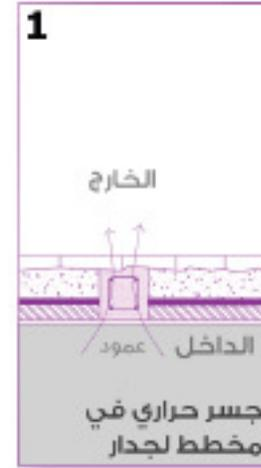
توضح المقاطع التالية ٤،٣،٢،١ تشكل جسور حرارية عند تعرض تلك المواضع التي تفتقد إلى العزل الحراري لفقدان حراري عال يزيد عن ذلك الحاصل من الأجزاء المجاورة لها ذات موصلية حرارية مختلفة.
