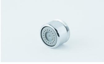
ب- قطع توفير المياه للحنفيات (الهوائية): هي قطعة يمكن تركيبها على رأس الحنفية تعمل على خلط الهواء بالماء مما يؤدي إلى توفير كمية المياه دون الشعور بأي فارق في كمية المياه المتدفقة، تحتوي قطعة التوفير أيضا على مصفاة مقببة الشكل لتصفية المياه من الشوائب والرواسب.
