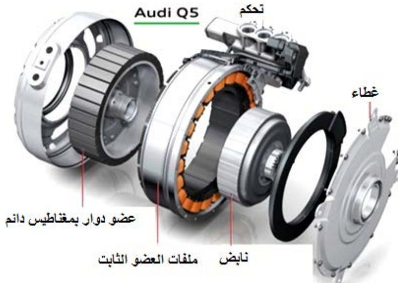
الشكل (44): مكونات محرك كهربائي مزود بمغناطيس دائم
