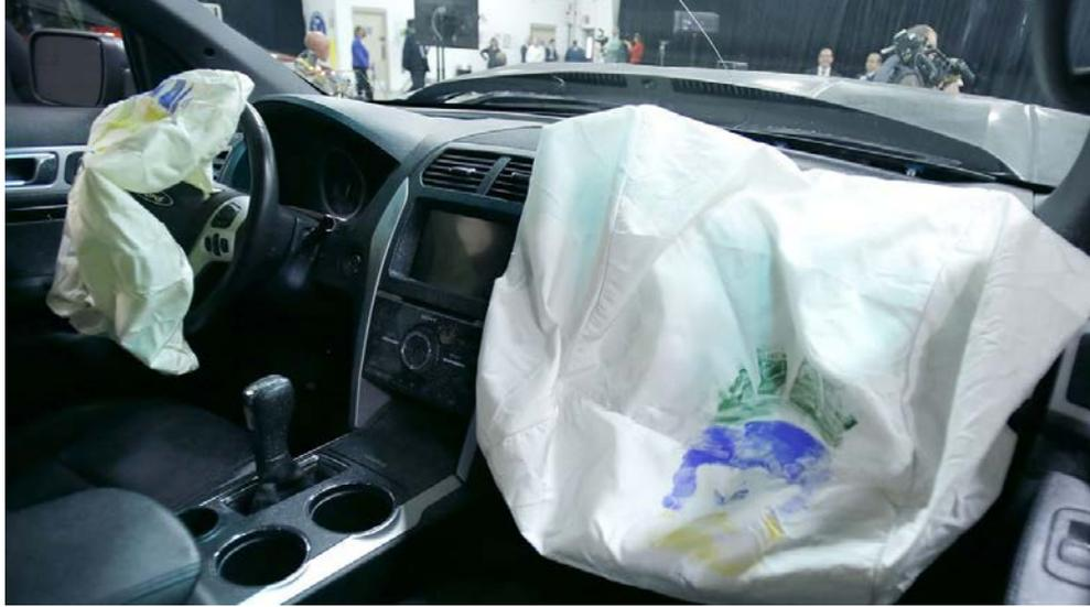
الشكل (4): خروج الهواء من الوسادة الهوائية
